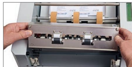
Die Messerkassette kann sehr einfach entnommen und gewechselt werden z.B. für Perforier- oder Rillmesser
