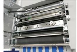
Der Rill-/Falzautomat Morgana DigiFold Pro XL von Mehring bei Richter verfügt über ein farbiges Bedienpanel, ist beim Werkzeugwechsel einfach zu handhaben, produziert exakt (wie hier ein Letter-Fold-Prospekt) und ist sehr solide gebaut.
