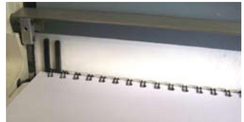
4. Das Bindeelement ist korrekt geschlossen
