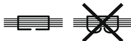
Flachklammerheftung für geringes Ablagevolumen
