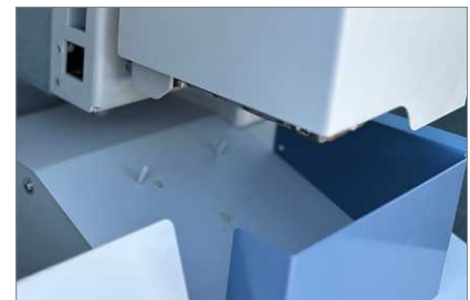
Verbesserter Klebstoffapplikator, immer mit geschlossenem Behälter, geeignet für EVA- und PUR-Kleber.
